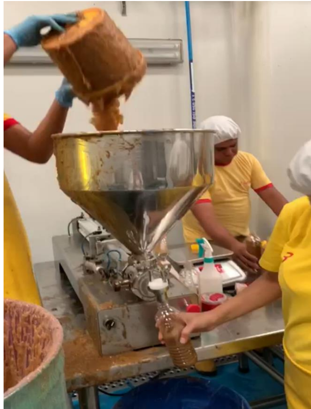
Figura 2. 2. Sistema de llenado de botellas actual [Elaboración propia]
