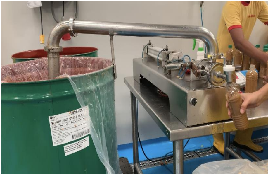
Figura 3. 2. Sistema de llenado con la nueva adaptación [Elaboración propia]
