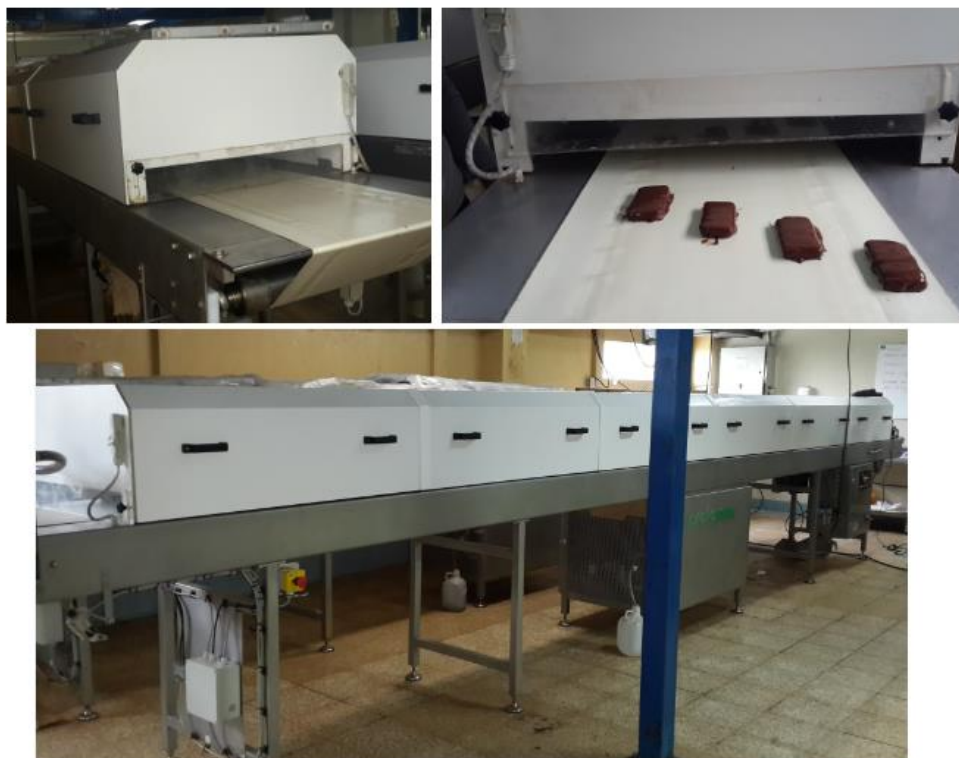
FIGURA 2.4 TUNEL DE ENFRIAMIENTO TIPO LIGHT FUENTE: INGRID LUCIN, 2016
