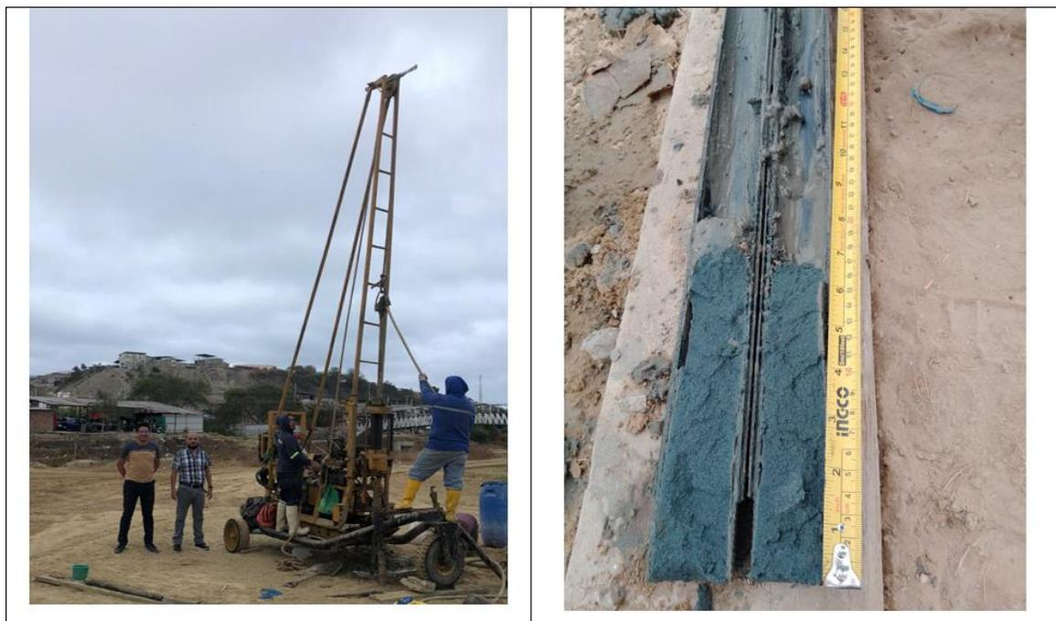
Figura 2.5 Toma de muestra para ensayo SPT-2
