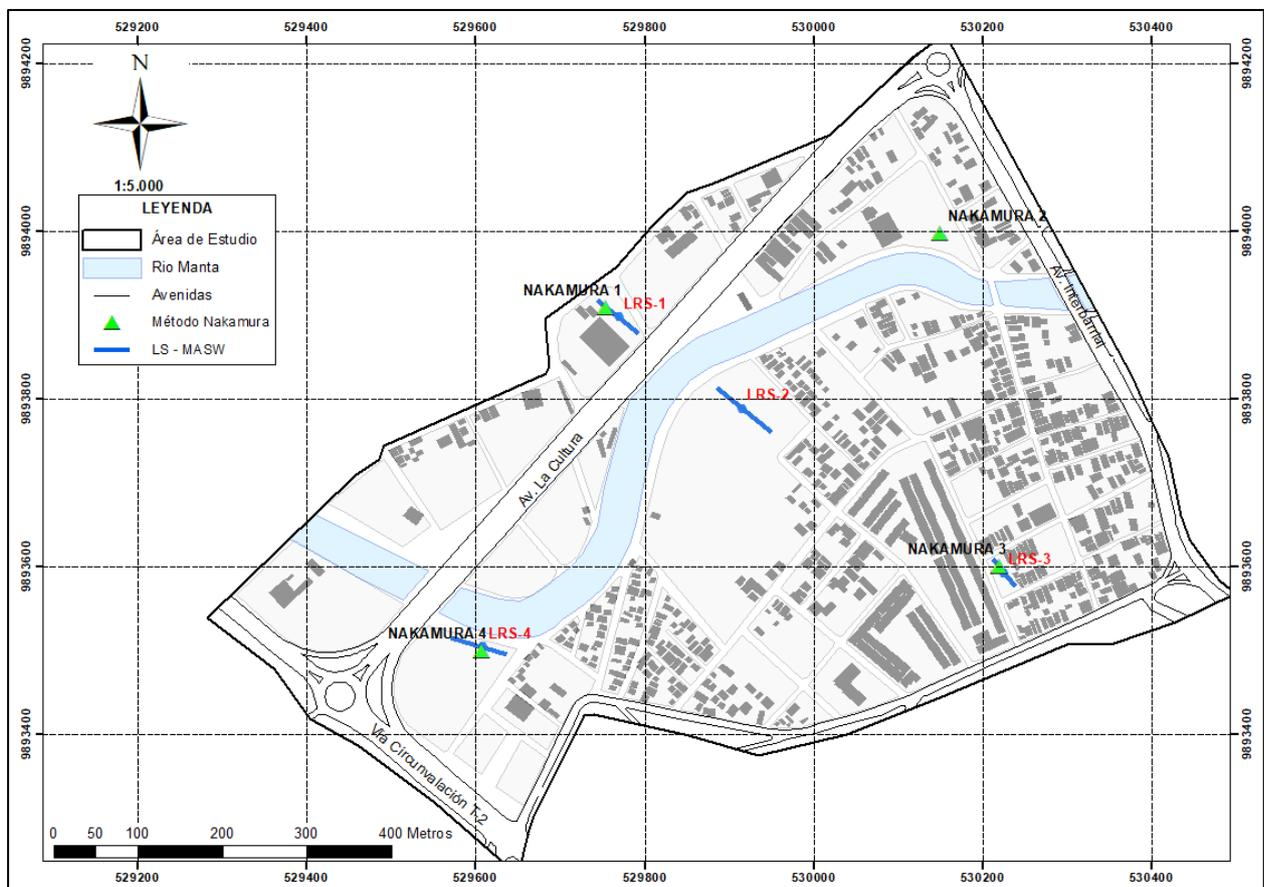
**Figura 2.13 Distribución espacial de ensayos Geofísicos**
