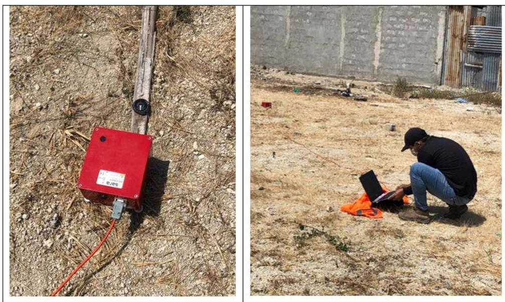
Figura 2.11 Ensayo método de Nakamura
