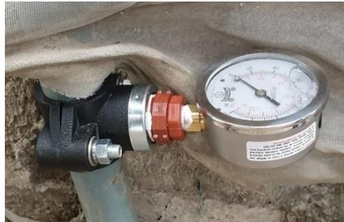
**Figura 2.4 Manómetro acoplado a la tubería principal de 32 mm**
