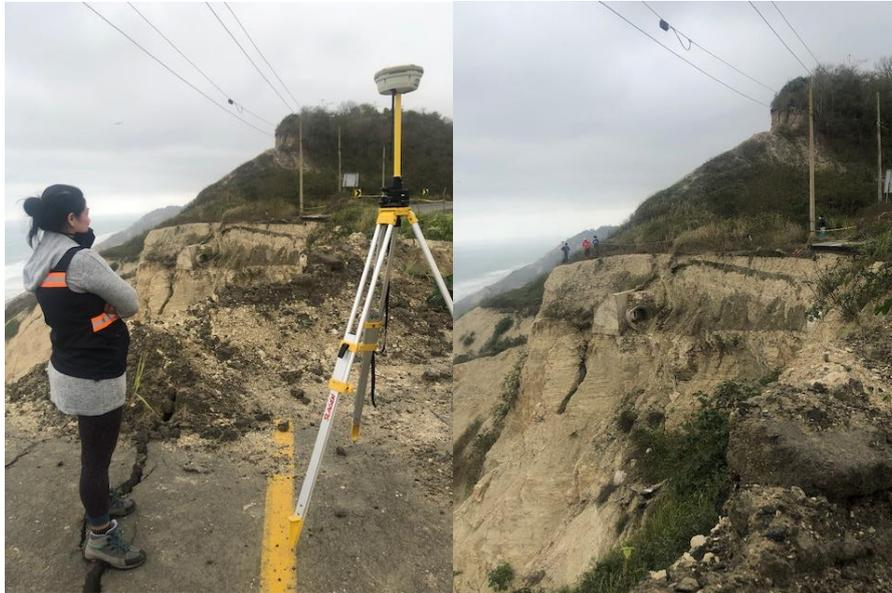
**Foto 2.4** Levantamiento topográfico con RTK
