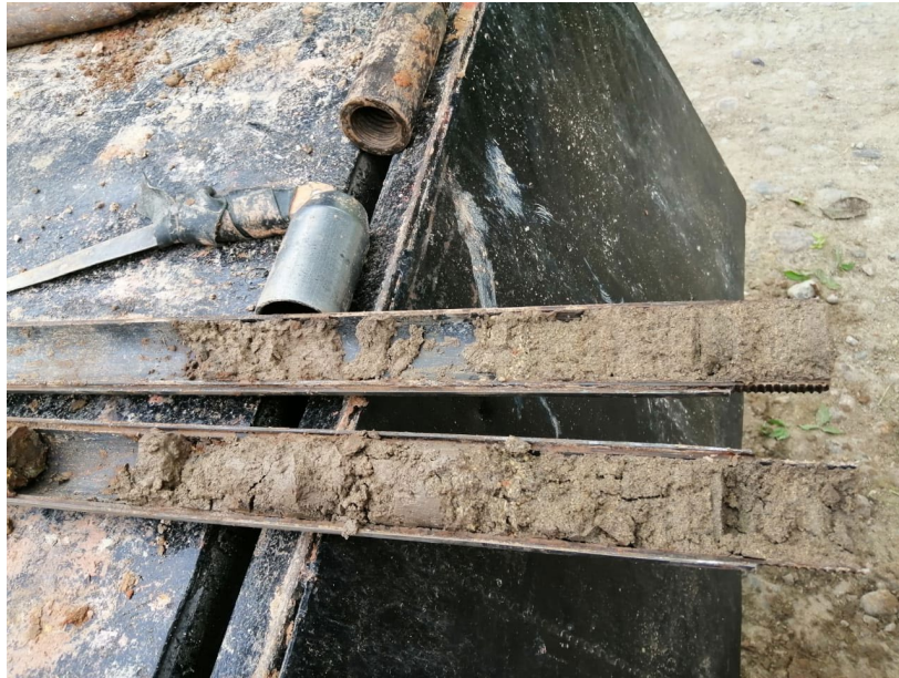
Figura 3.15 Muestreo mediante el tubo shelby en el talud 25+280. Fuente: Suelcon & Asf.
