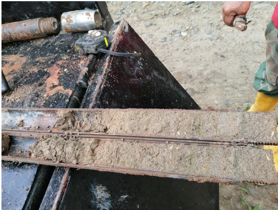
Figura 3.14 Muestreo mediante el tubo shelby en el talud 25+280. Fuente: Suelcon & Asf.
