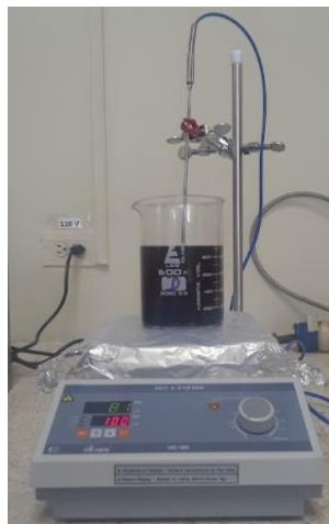
Figura D. 11 Proceso de decoloración de aceite de domicilio con carbón activado con una de proporción de 25:1
