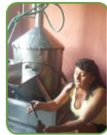
Por condensación el agua y el aceite se separan, es así como se obtiene el aceite de palo santo y el agua puede ser recogida y utilizada nuevamente. Este proceso tiene una duración de cinco horas aproximadamente.
