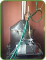
Luego se introduce la madera en el alambique y se tapa herméticamente, también se colocará agua la misma que llegará al punto de ebullición y posteriormente evaporación, este vapor saturado realiza el arrastre de los aromas en forma de líquido.
