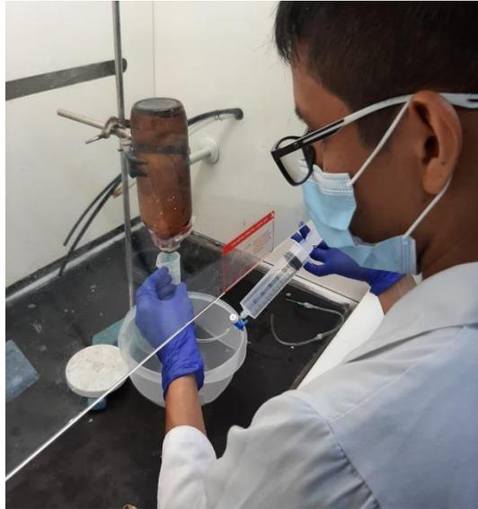
**Figura 2.9.** Sistema de medición de metano
