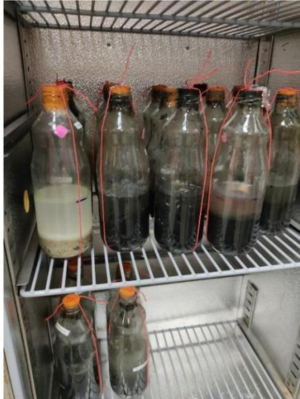
**Figura 2.7.** Incubación de reactores anaeróbicos
