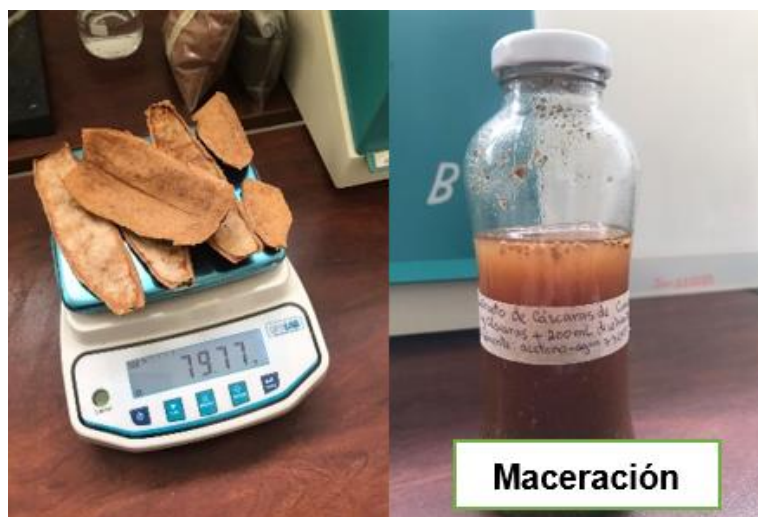
Figura 2.8 Elaboración del extracto de cáscaras de cacao
