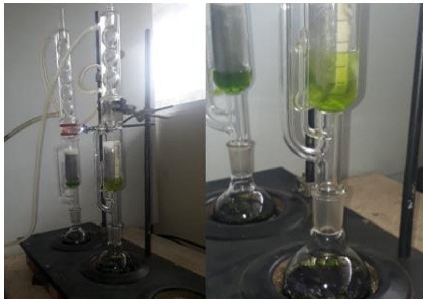
Figura 2.9 Elaboración del extracto etanólico de Laritaco
