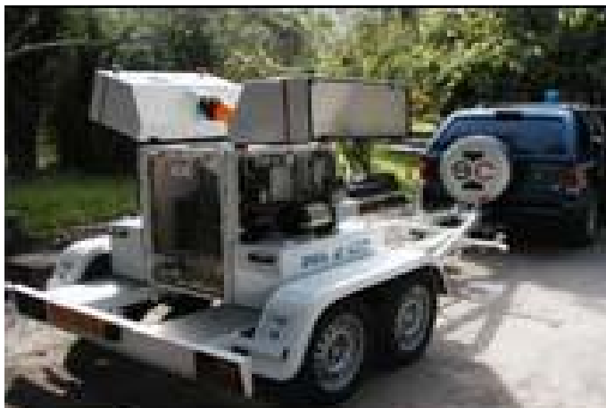
FOTO No. 3.4.- Toma de ensayo de FWD
