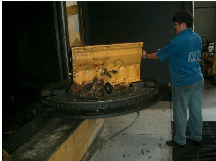
**FIGURA 2.6** PROCESO DE LAVADO DE LOS MOTORES A DIESEL
