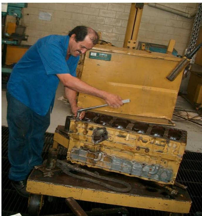
**FIGURA 2.5** PROCESO DE DESARMADO DE LOS MOTORES DE GRUPO DE BOMBEO
