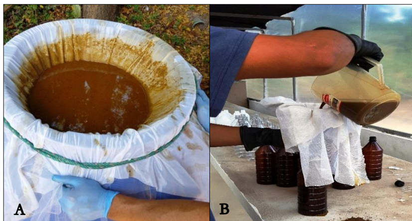
Figura 1. A) Separación de las fases sólidas y líquidas del BF. B) Envasado del BF en botellas PET (T-28).
