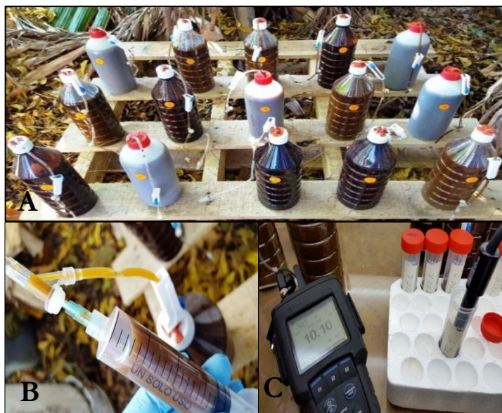
Figura 2. A) Envases con el BF en temperatura ambiente (27°C). B) Toma de muestra del BF (50 mL) con una jeringuilla. C) Toma de parámetros físico-químicos con el multiparámetro.
