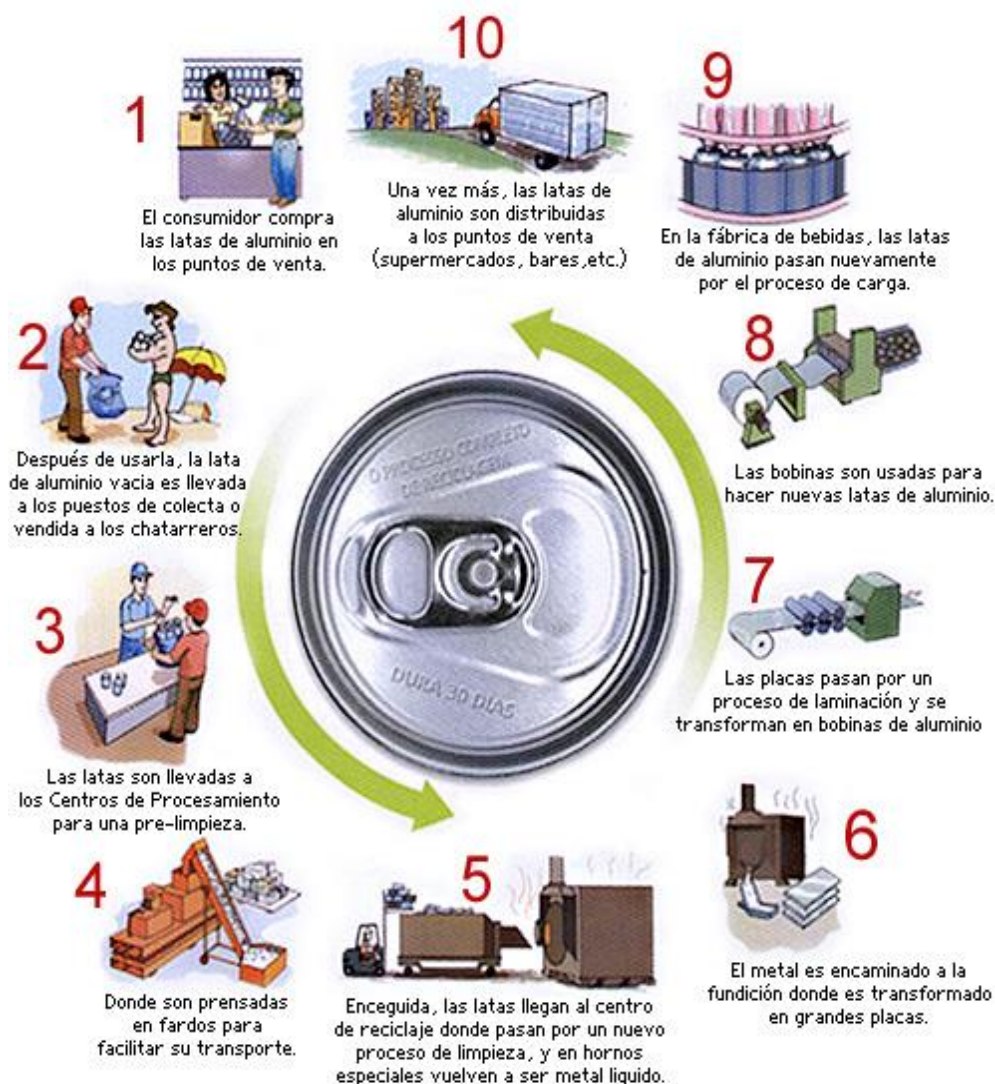
Ilustración 4.26. Proceso de reciclaje de latas de aluminio
