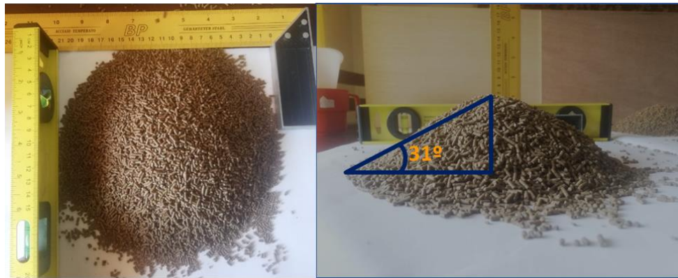
Figura 2.7 Estimación de ángulo de talud natural de alimento para camarón
