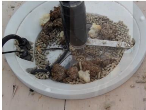
Figura 1.11 Regulación de alimento con paso tipo licuadora [30]
