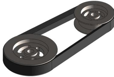
**Figura 2.15. Transmisión por banda**
