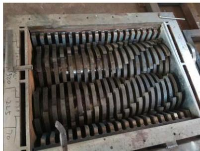
**Figura 1.5 Trituradora de cuchillas
