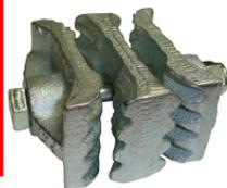
La mordaza mecánica Vise-Splice está diseñada para bandas elevadoras de hasta 800 PIW o 1400 N/mm. Se compone de tres piezas, dos externas y una interna.
