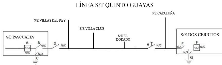
**Figura 1.9: Diagrama Unifilar de las líneas de Subtransmisión del Distrito Aurora – Vía Salitre**
