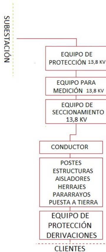
**Fig. 3.7: Diagrama de bloques de los alimentadores de la Subestación VILLA CLUB para implementación de RCM**
