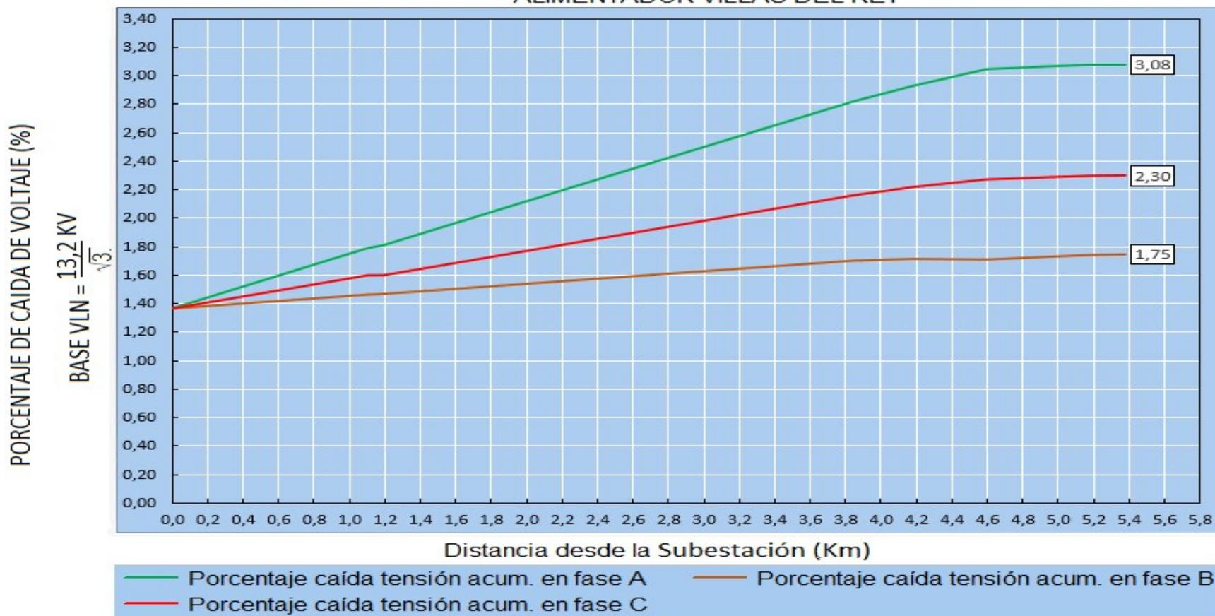
Fig. 2.15: Perfil de Caída de Voltaje por fase en Alimentador VILLAS DEL REY. Año 2018.
