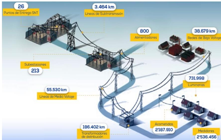
**Figura 1.5: Principal Infraestructura eléctrica de CNEL EP**
