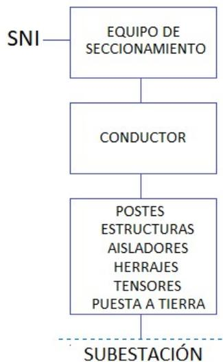
**Fig. 3.3: Diagrama de bloques de la línea de Subtransmisión Quinto
