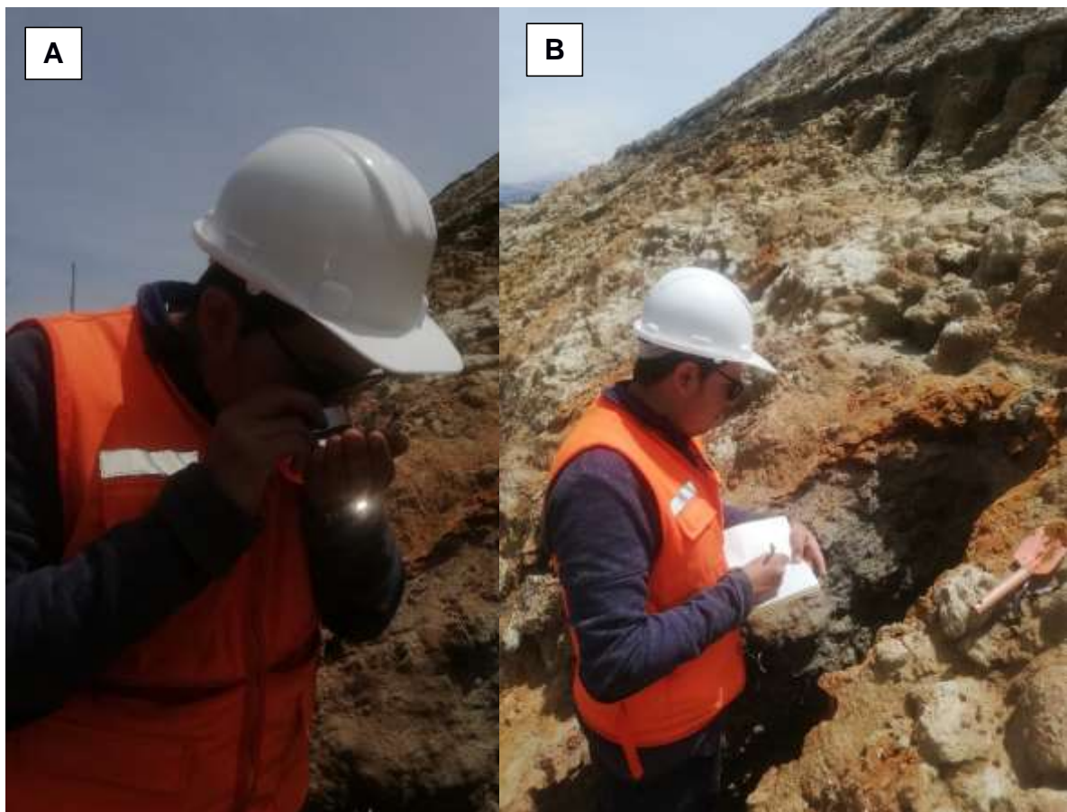
Figura 3.13 (A) Caracterización de los diferentes minerales mediante el uso de herramientas como lupa y rallador/imán y (B) Descripción de las arenas del relave . Fuente: Autor
