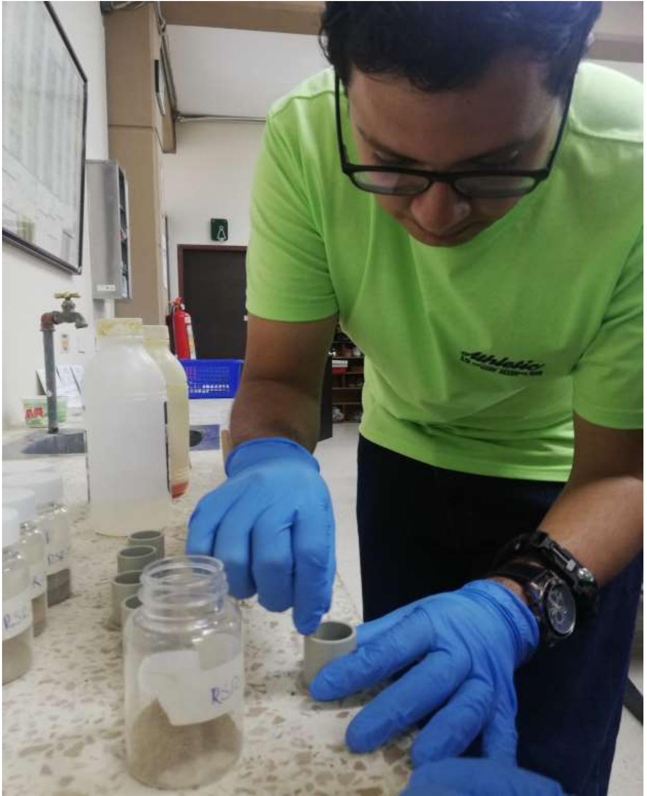
Anexo B.2. Figura en donde se como se mezcla el pegamento con la arenas dentro del tubo. Fuente: Autor
