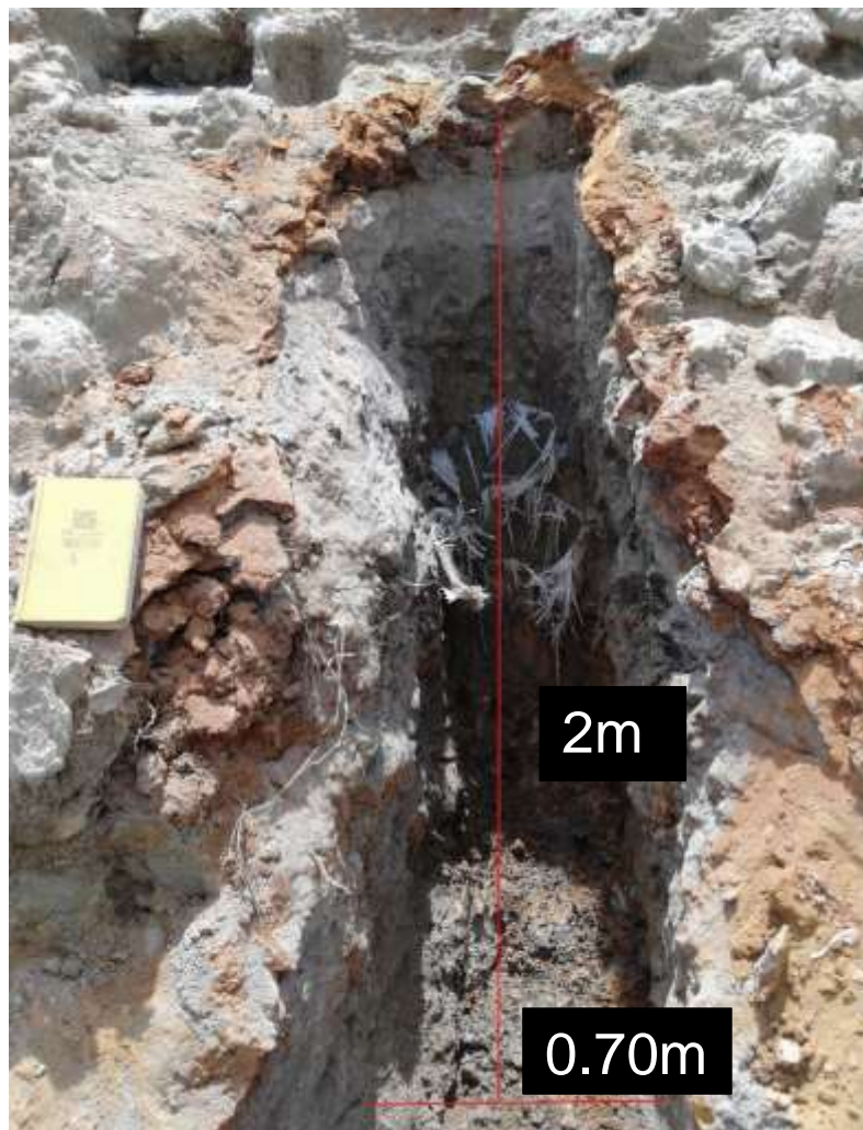
Figura 3.12 Elaboración de las calicatas para muestreo de 2m de alto y 0.70 m de ancho. Fuente: Autor
