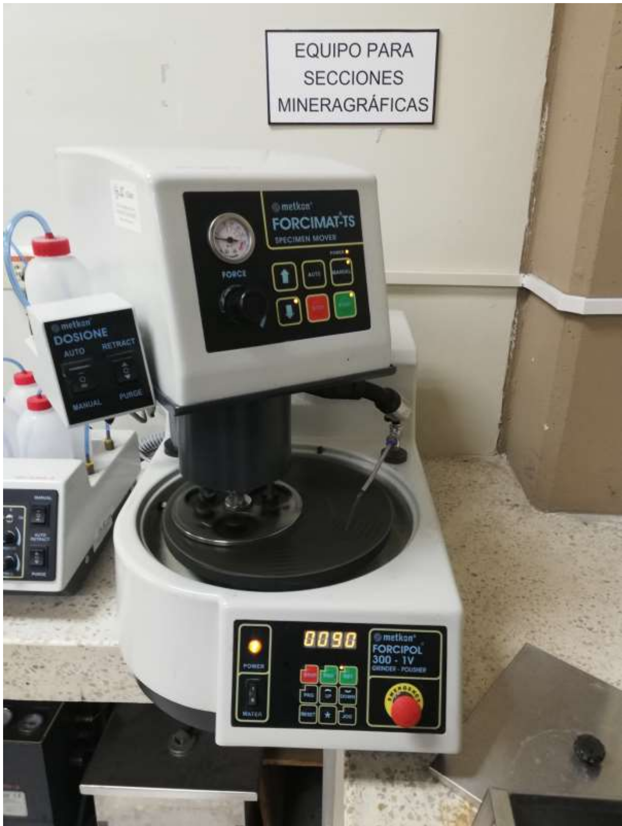
Anexo B.3. Figura en donde se la maquina que se utiliza para pulir ubicada en el laboratorio de petrología.
