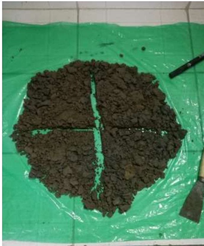
Figura 3.21 Uso del método del cuarteo para la realización de secciones pulidas. Fuente: Autor
