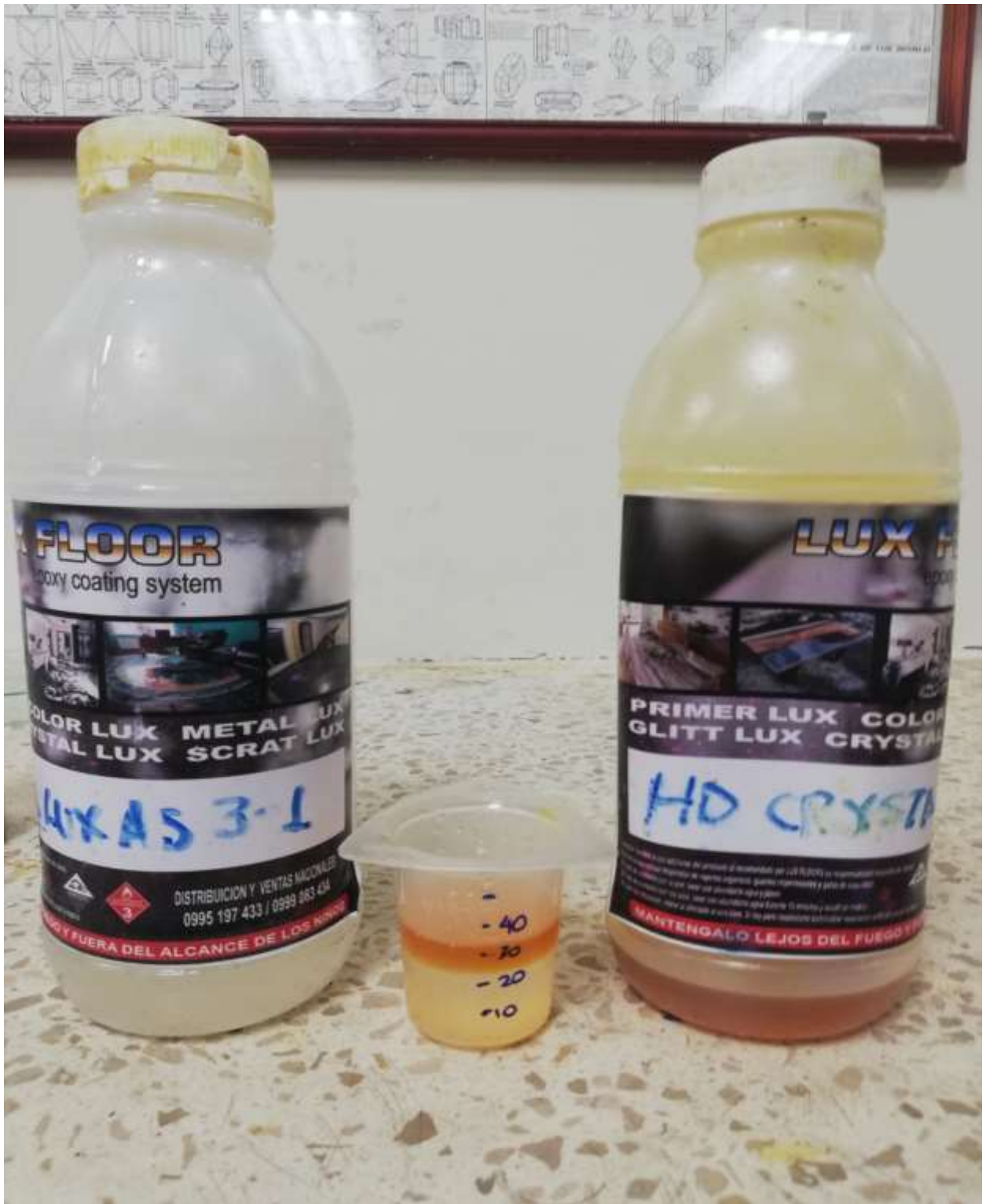
Anexo B.1. Figura en donde se observa la resina (derecha) y el endurecedor (izquierda) utilizados para la creación del pegamento. Fuente: Autor
