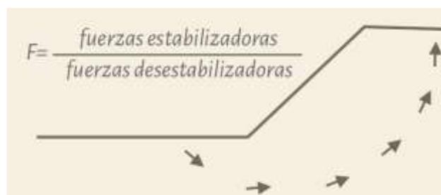
**Figura 2.3 Esquema de estabilidad de talud. Fuente: (Ricardo et al., 2015)**
