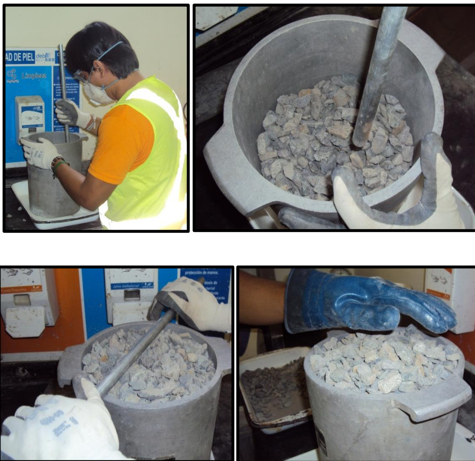
Ilustración 3. 16 Procedimiento para Determinar Masa Unitaria-Agregados Gruesos.
