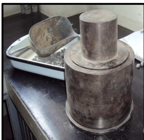
Ilustración 3. 11 Varillado y Colocación de Muestra en Presas.
