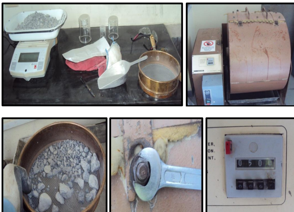
Ilustración 3. 23 Procedimiento para Ensayo de Abrasión.
