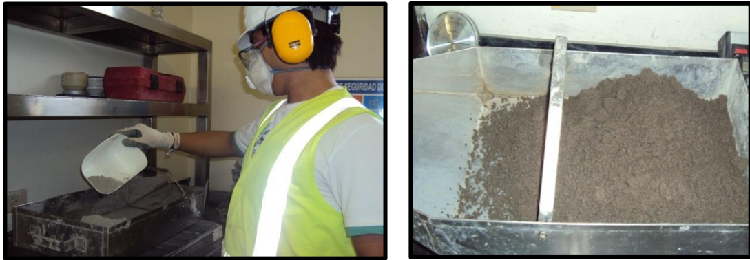
Ilustración 4. 15 Pesando Arena para Diseño de HCR.
