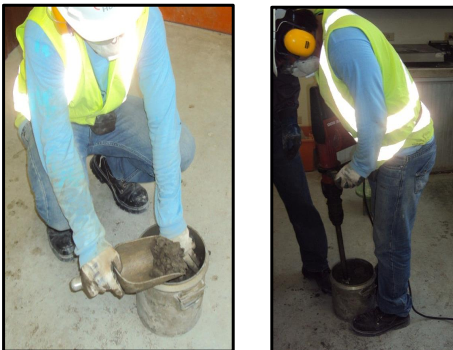
Ilustración 4. 18 Llenando Olla de Washington para Determinar la Densidad.
