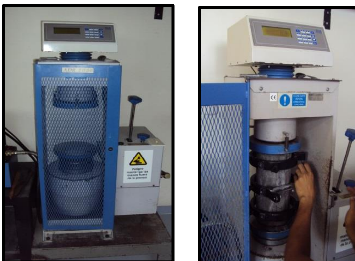
Ilustración 5. 5 Prensa de Capacidad de 2000KN.
