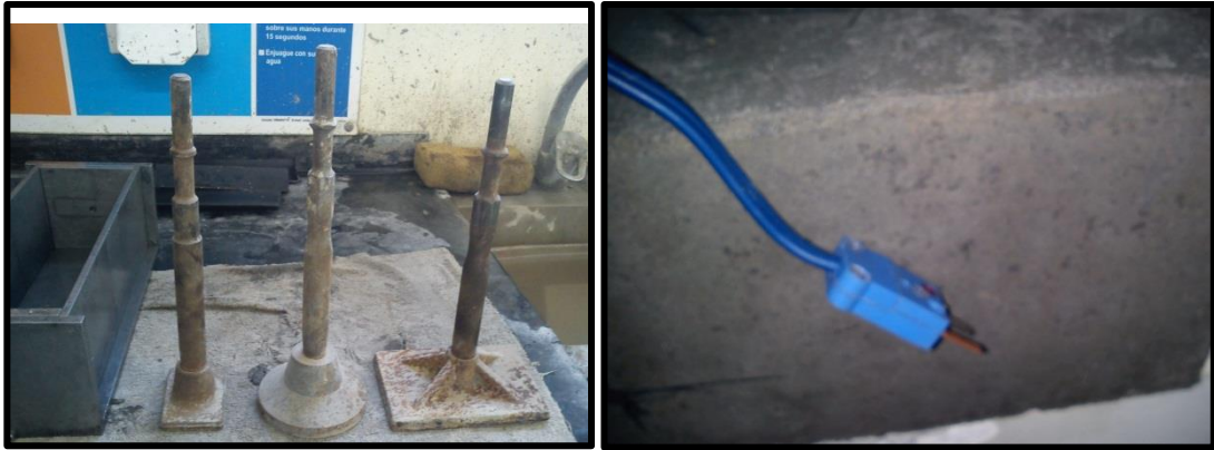
Ilustración 5. 12 Apisonadores y Termocoplas.
