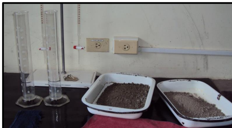
Ilustración 3. 20 Determinación Materia Orgánica.
