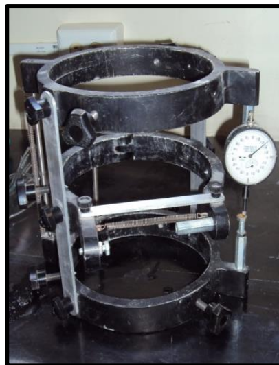
Ilustración 5. 6 Extensómetros para Medir Deformación de Cilindros.
