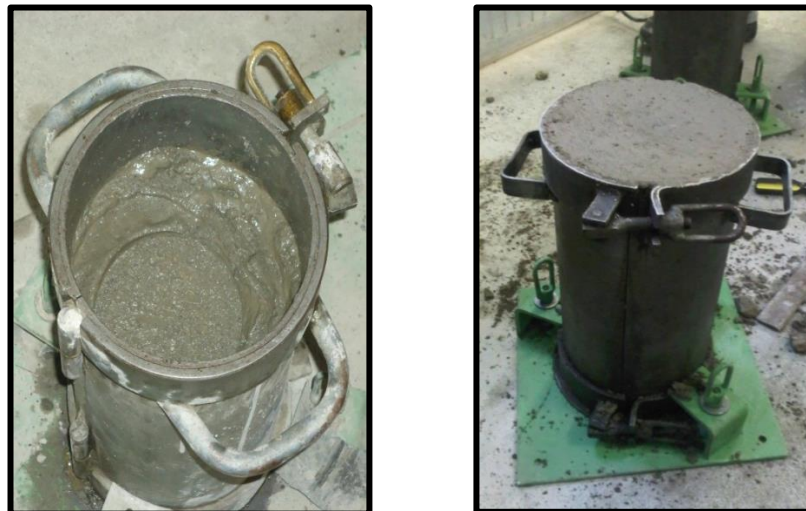
Ilustración 4. 19 Elaboración de Especímenes.
