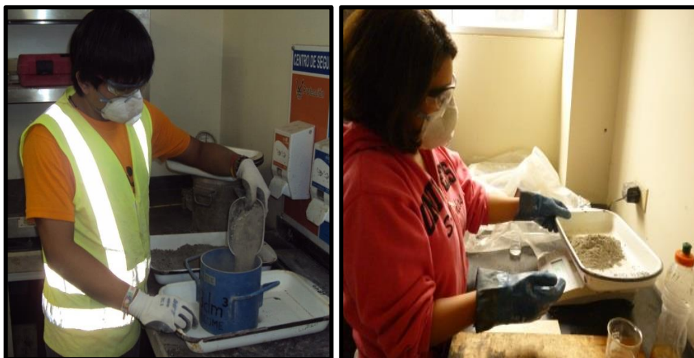
Ilustración 3. 17 Procedimiento para Determinar Masa Unitaria-Arena.
