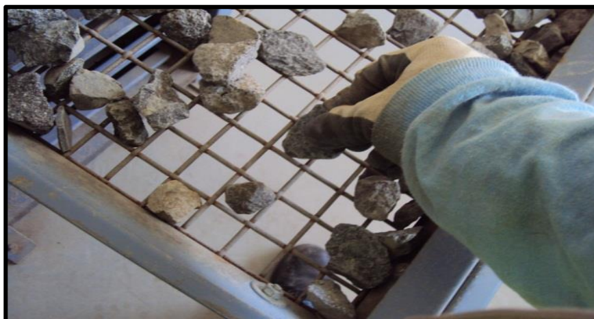
Ilustración 3. 6 Granulometría Piedra 38mm.
