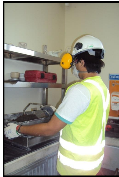
Ilustración 4. 14 Pesando Piedra #4 para Diseño de HCR.
