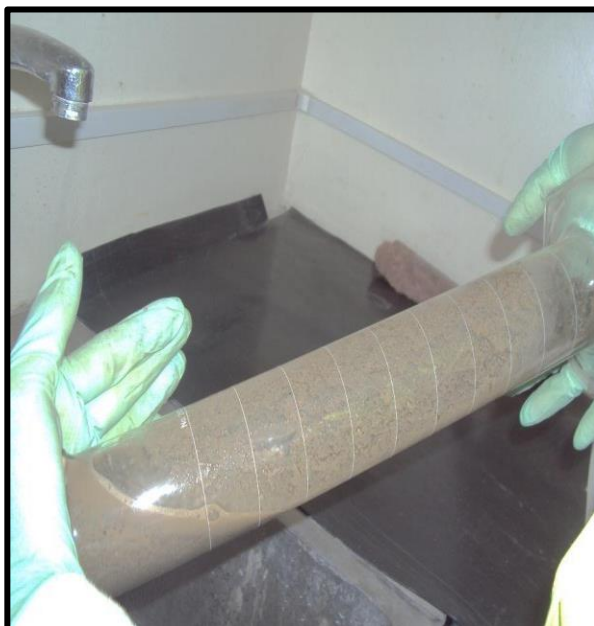
Ilustración 3. 19 Vertiendo Solución con Agua a la Arena.
