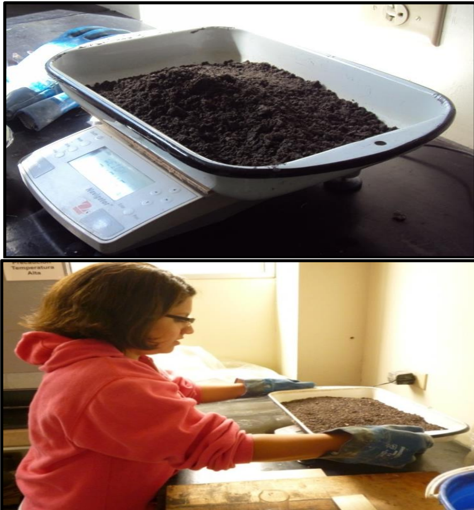
Ilustración 3. 14 Peso Agregados Finos para Determinar Densidad y Absorción.
