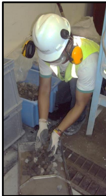
Ilustración 4. 14 Pesando Piedra #4 para Diseño de HCR.
