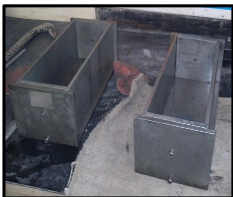
Ilustración 5. 11 Elaboración Especímenes para Coeficiente de Dilatación Térmica.
