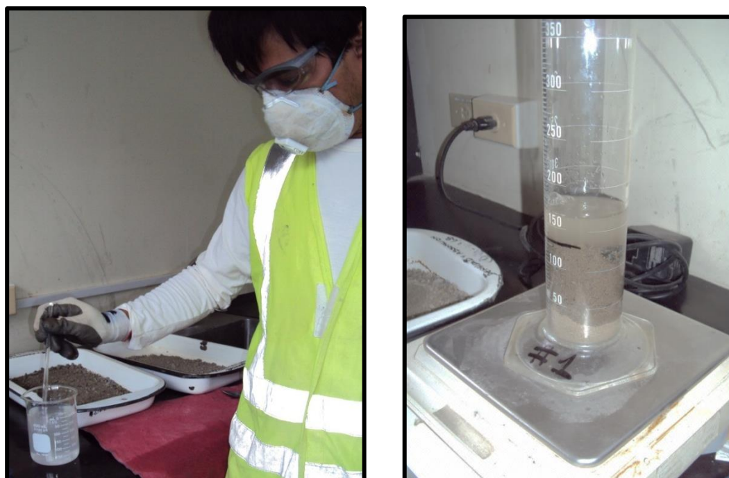
Ilustración 3. 18 Preparación de Solución de Hidróxido de Sodio.
