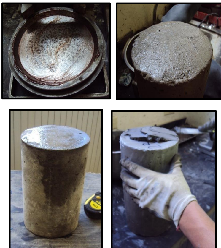
Ilustración 5. 3 Colocación de Mortero a los Especímenes.
