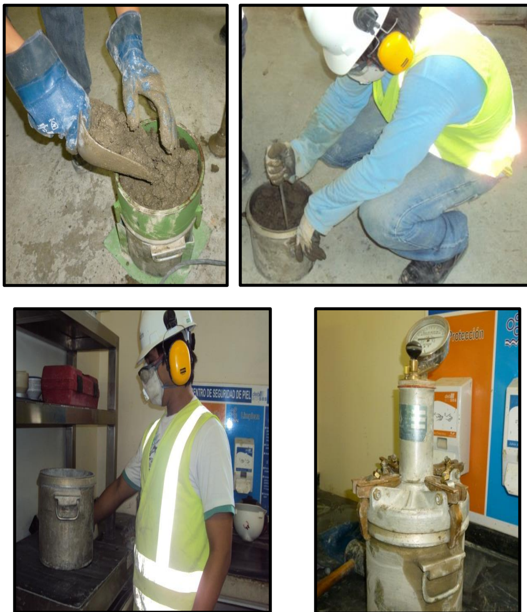
Ilustración 4. 13 Determinación de Densidades.
