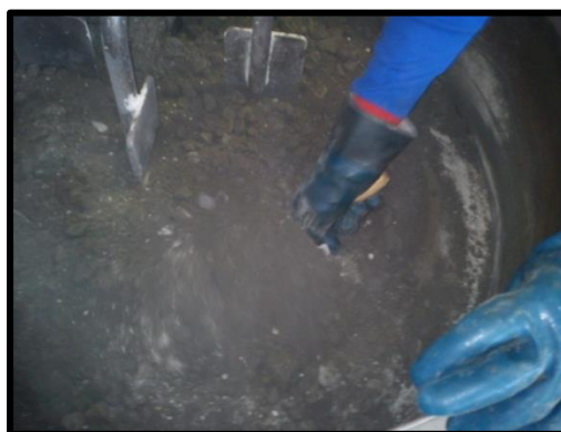
Ilustración 5. 11 Elaboración Especímenes para Coeficiente de Dilatación Térmica.
