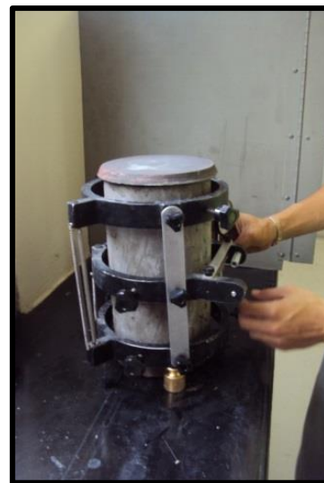
Ilustración 5. 6 Extensómetros para Medir Deformación de Cilindros.
