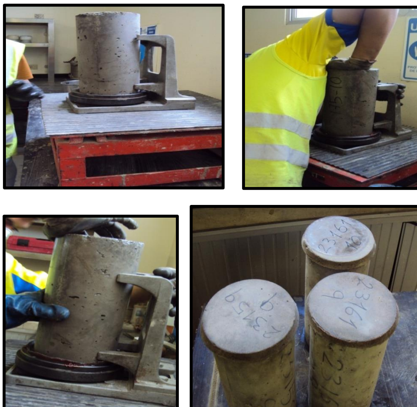
Ilustración 5. 4 Proceso de Vibración y Acabado del Refrentado.
