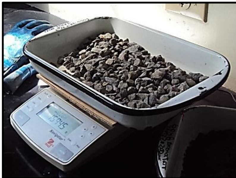
Ilustración 3. 13 Peso Agregados Gruesos para Determinar Densidad y Absorción.
