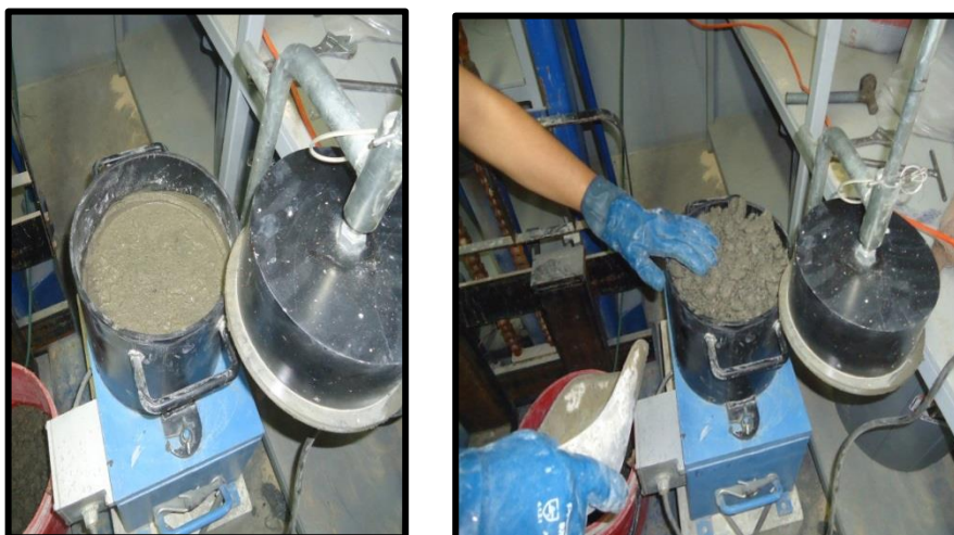
Ilustración 4. 17 Ensayo Vebe, Determinación de Trabajabilidad.
