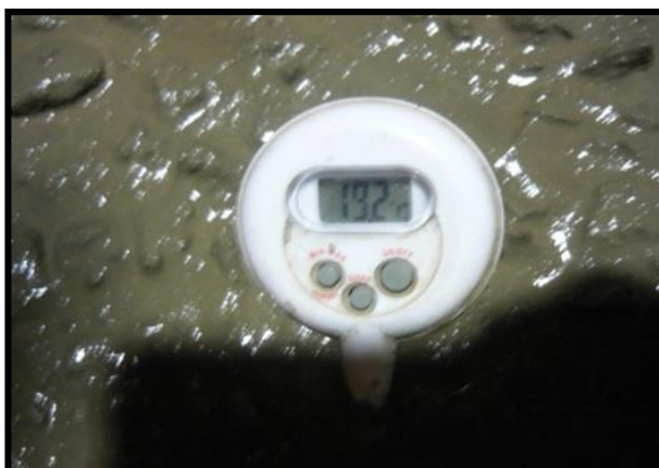
Ilustración 9. 7 Dispositivo para Medir la Temperatura en el HCR Fresco, Tomado de la Presentación HCR Evolución y Nuevos Horizontes - Ing. Miguel A. Golik.
