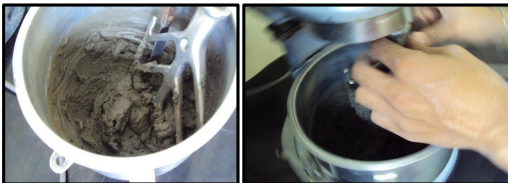
Ilustración 5. 1 Mezclado de Mortero para Refrentar.
