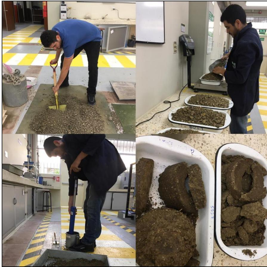
**Figura 2. 27 Desarrollo del ensayo de Proctor Modificado en las instalaciones del laboratorio.**
