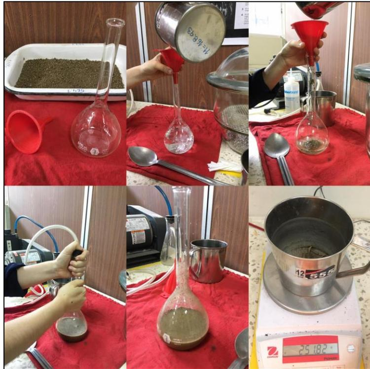
Figura 2. 29 Desarrollo del ensayo para el cálculo de la gravedad específica.
