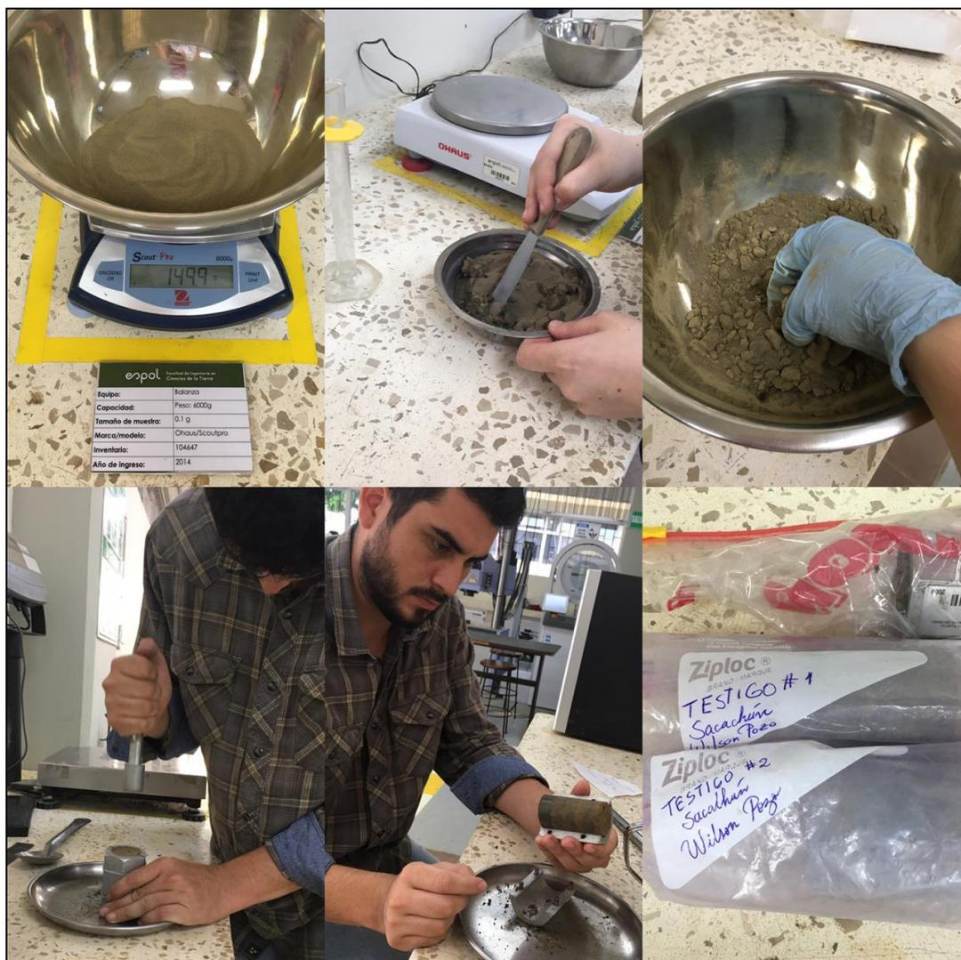
Figura 2. 25 Preparación de la muestra (3 testigos) para realizar el ensayo triaxial.
