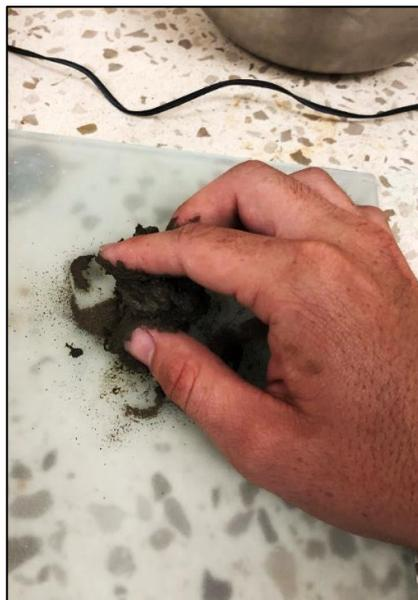
**Figura 2. 23 Realización del ensayo de limite plástico**
