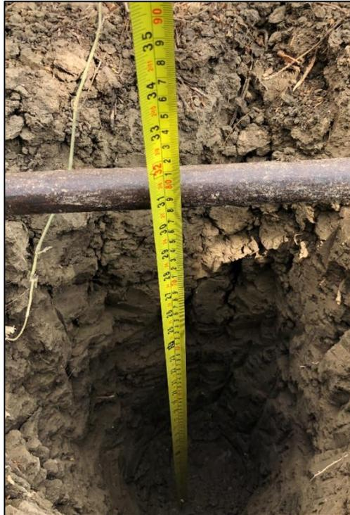
**Figura 2. 17 Elaboración de calicatas a 0.80 m bajo la superficie.**
