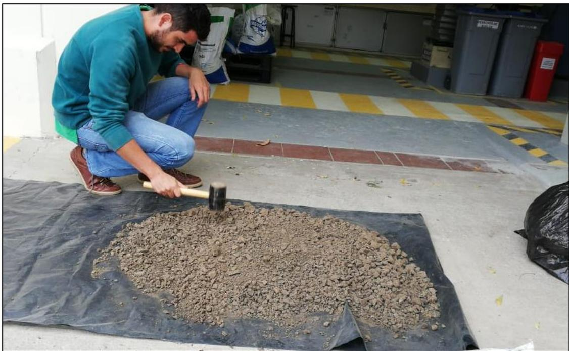
**Figura 2. 20 Secado de las muestras en las instalaciones del Laboratorio de Suelos.**
