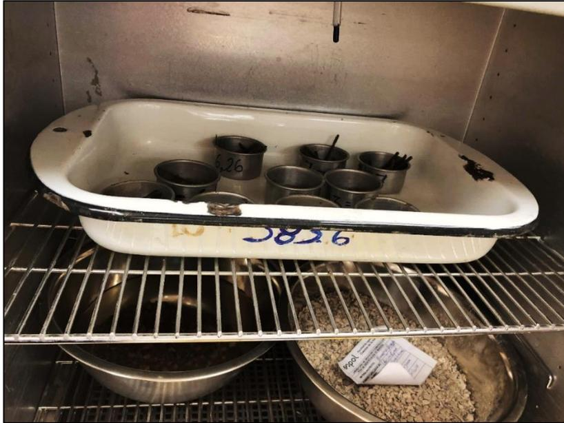
**Figura 2. 24** secado de muestras para obtención de contenido de humedad, y límites.
