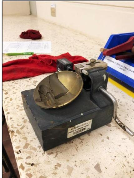
**Figura 2. 22 Ensayo limite liquido (Copa de Casa Grande)**
