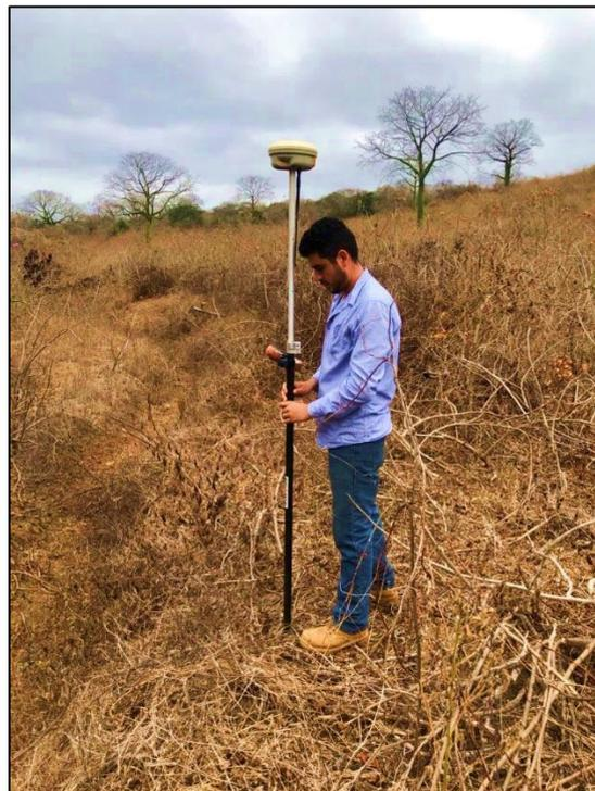
**Figura 2. 7 Toma de puntos topográficos con GPS diferencial.**
