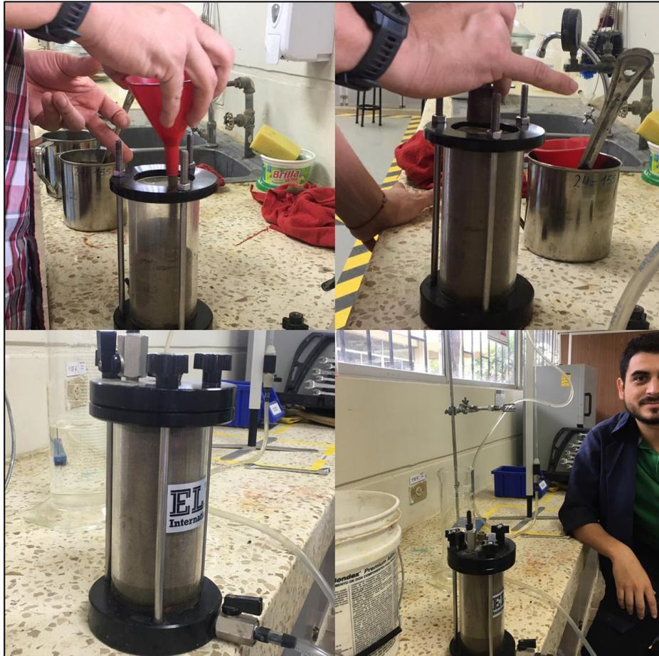
Figura 2. 28 Desarrollo del ensayo para el cálculo de la permeabilidad.
