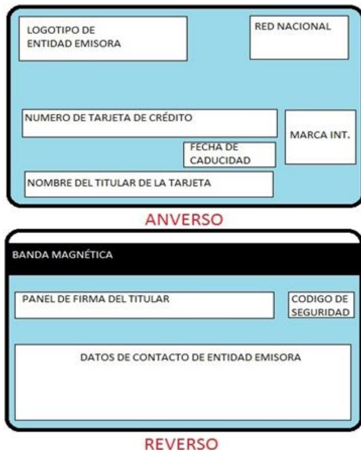
FIGURA 3.10 Estructura de una Tarjeta de Crédito Magnética
