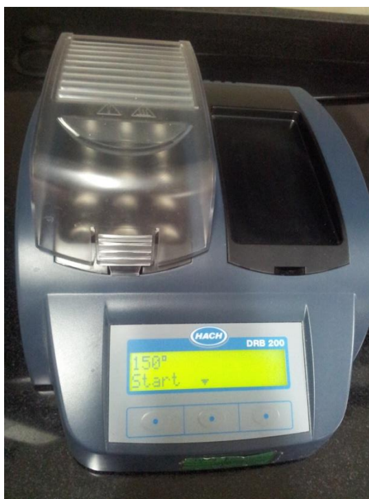
Figura 3.7. Termorreactor utilizado para la digestión de las muestras Marca: HACH, Modelo: DRB 200.
