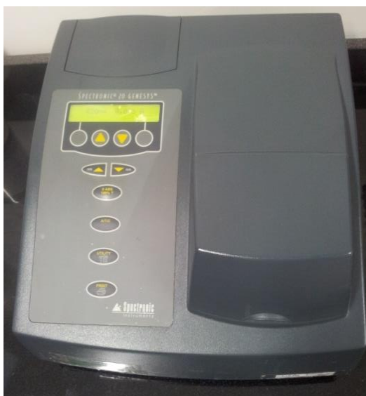
Figura 3.6. Espectrofotómetro utilizado para la medición de la absorbancia a 510 nm para Fenoles. Modelo: 20 Genesys.
