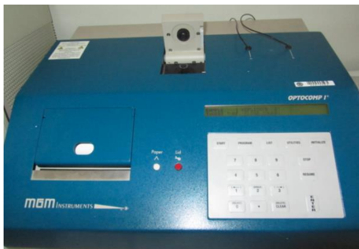
Figura 3.2. Equipo utilizado para la medición de luminiscencia, Marca: Microtox, Modelo: OPTOCOMP 1
