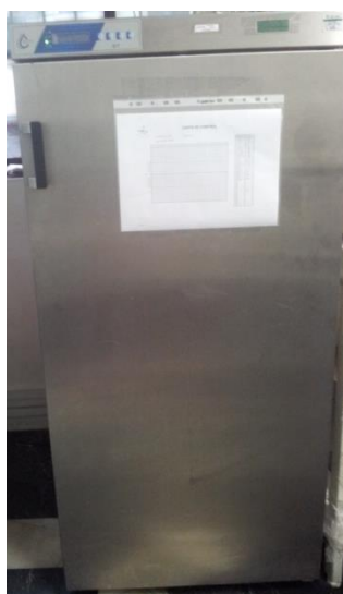
Figura 3.9. Incubadora a 15^{\circ}\text{C} utilizado para análisis de DBO5
