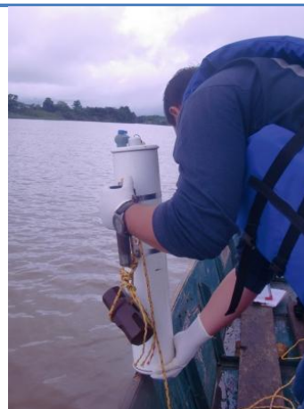
Muestreo de la columna de agua con Botella NISKIN
