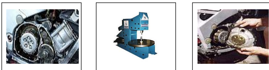
Figura 2.10.4: Remachada de discos de embrague de vehículos pesados
