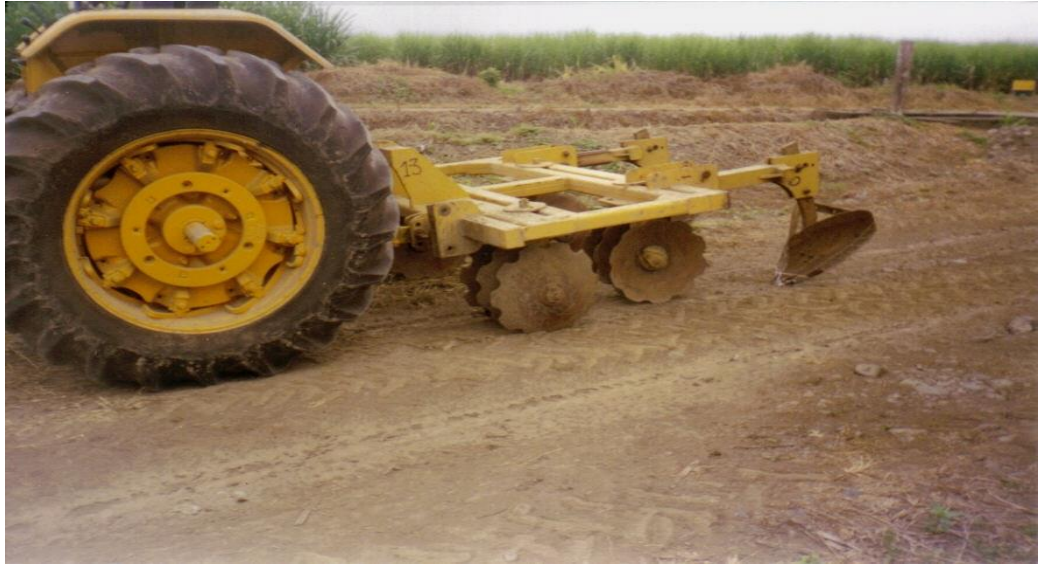
FIGURA 1.8 ILUSTRACION DE EQUIPO CULTIVO APORCADOR DE DISCOS.
