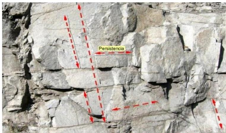
**Figura 2.5 Ejemplificación de la separación de juntas**
