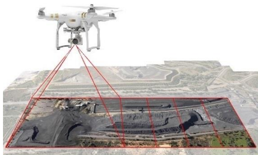
FIGURA 6. Levantamiento fotogramétrico. Fuente:(Ríosantana, 2019)
