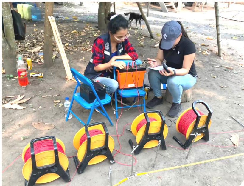
FIGURA 11. Equipo utilizado para sondeos geo eléctricos
