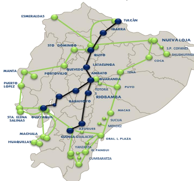
Ilustración 33. Red de Fibra óptica 2006-2011
