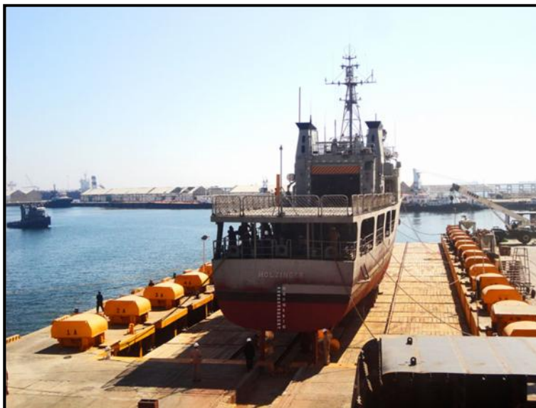
Figura 1. 3. Sincroelevador del Astillero ASTIMAR
