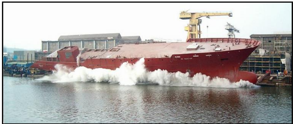
Figura 1. 8. Botadura de Carrera Transversal
