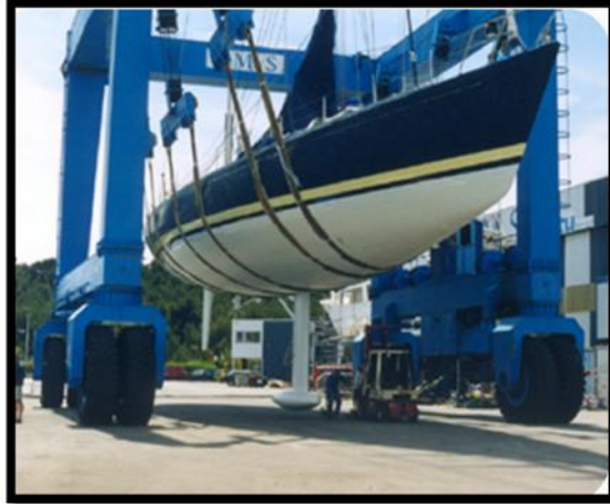
Figura 1.10. Varamiento con Grúas de Pórtico
