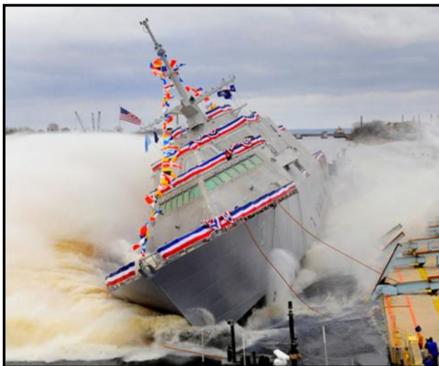
Figura 1. 5. Varada de Carrera Transversal
