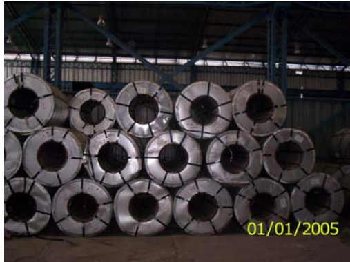
FIGURA 22. ALMACENAMIENTO DE BOBINAS: LAMINADOS EN FRÍO, LAMINADOS EN CALIENTE, ALUZINC Y GALVANIZADAS.
