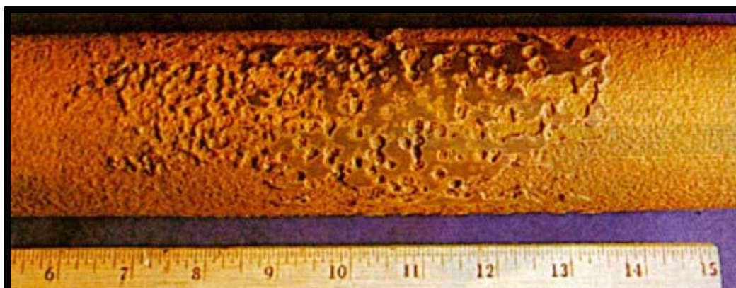
FIGURA 1.8. DAÑO PRODUCIDO POR ACCIÓN DIRECTA DE LA HUMEDAD EN COMBINACIÓN CON LOS DEPÓSITOS SULFUROSOS. (FUENTE: GUIA NALCO PARA EL ANALISIS DE FALLA EN CALDERAS)
