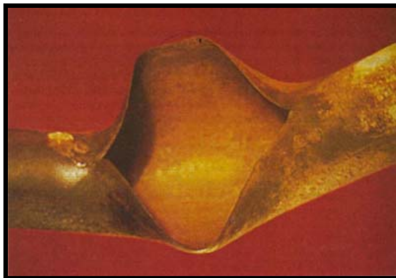
FIGURA 1.10. SOBRECIENTAMIENTO DE CORTA DURACION EN EL QUE SE TUVO COMBADURA ANTES QUE LA ROTURA. (FUENTE: GUIA NALCO PARA EL ANALISIS DE FALLA EN CALDERAS)
