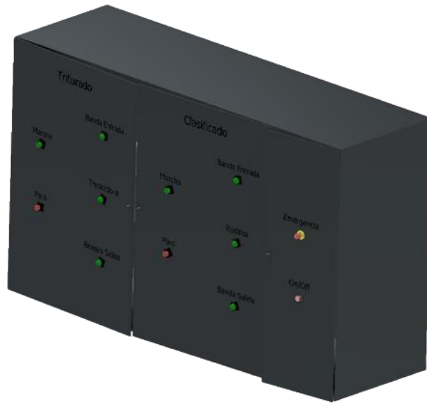
Figura 3.3 Tablero de control del sistema
