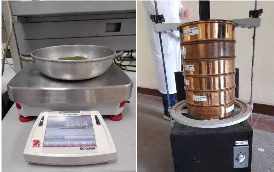
**Ilustración 2.8 Pesado de muestra inicial y proceso de tamización.**
