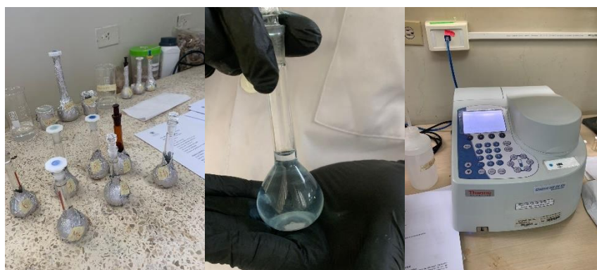
Figura 2.13 Determinación de fenoles usando el reactivo de Folin-Ciocalteu
