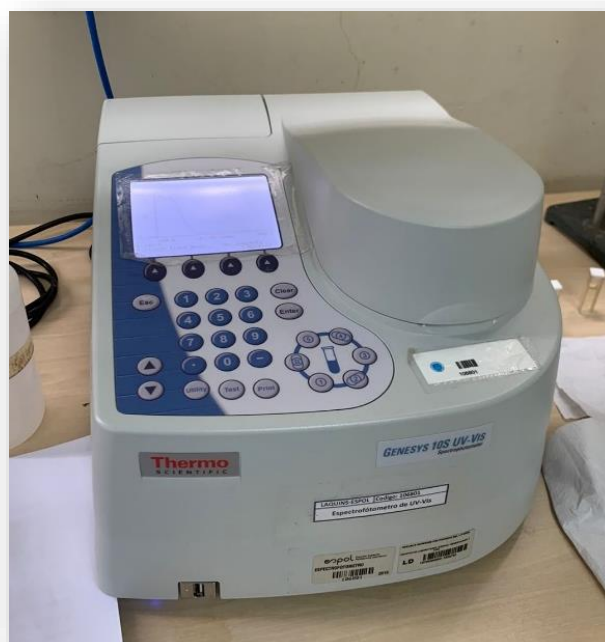
Anexo 6. Equipo espectrofotómetro UV-visible ubicado en laboratorio LAQUINS, usado para las lecturas de las curvas de calibración en la determinación de actividad antioxidante y fenoles en la bebida.
