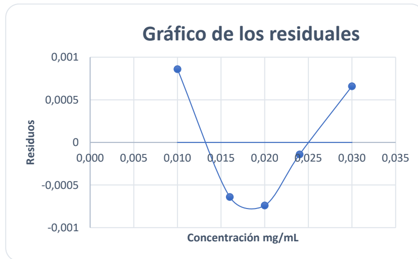
Fig. 4. 4. Gráfico de análisis de residuales de la curva de calibración de 0.010 mg/mL a 0.030 mg/mL
