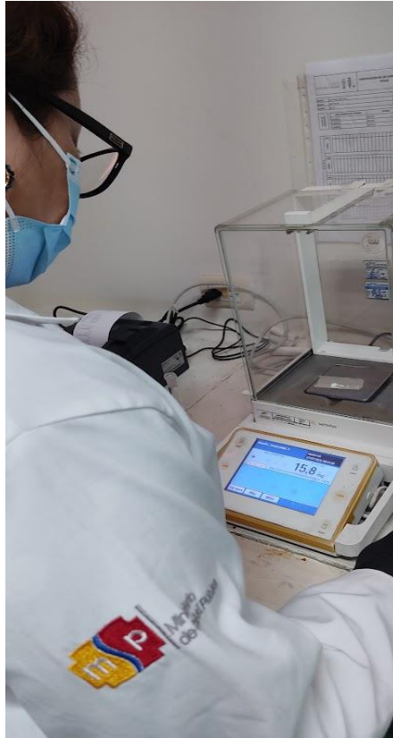
Fig. A13. Pesada de estándar clorhidrato de metoclopramida para nivel alto.
