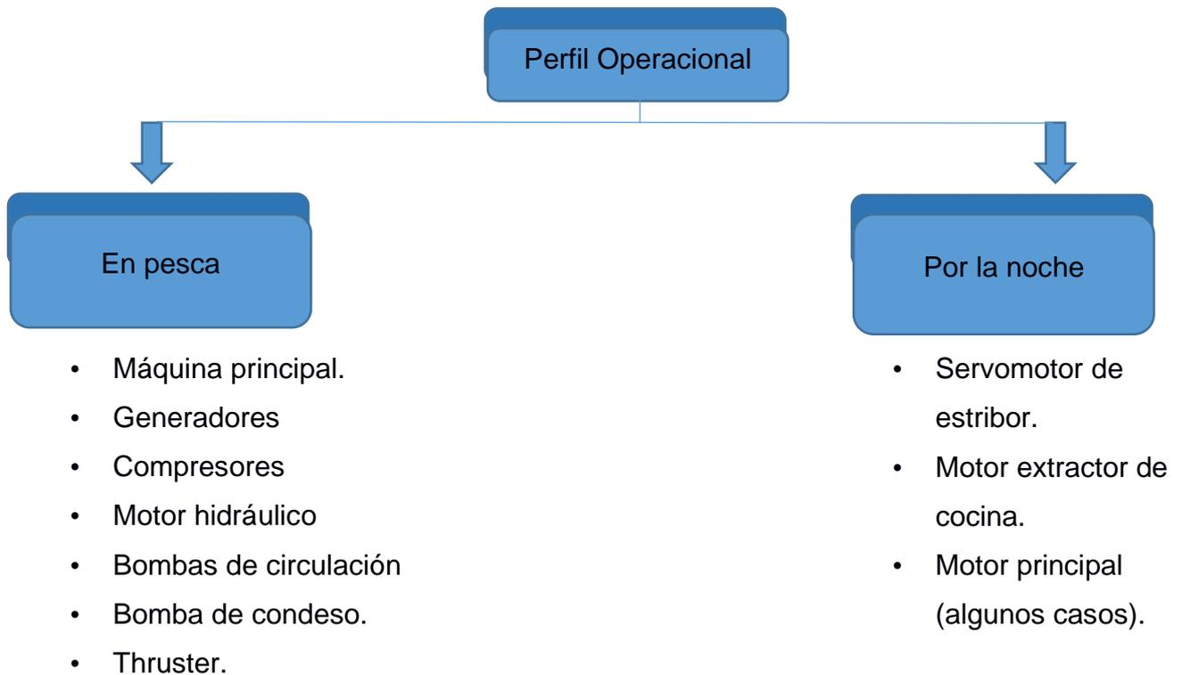
**Figura 3.2 Esquema operacional de uso de equipos para faena de B/P DRENNEC.**
