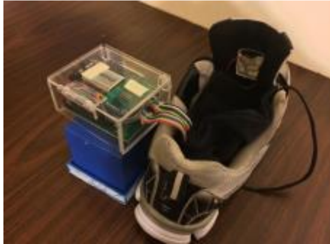
Figura 1.7 Estimulación vibratoria para reducir episodios de CDM [20]
