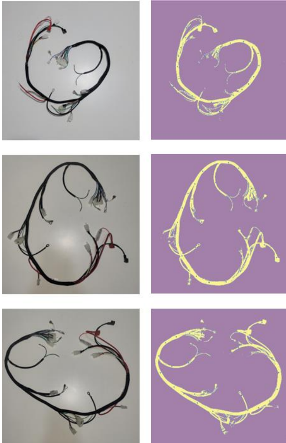
Figura 3.2 Pruebas del modelo con cables en varias posiciones. A la izquierda la imagen original, a la derecha el resultado.
