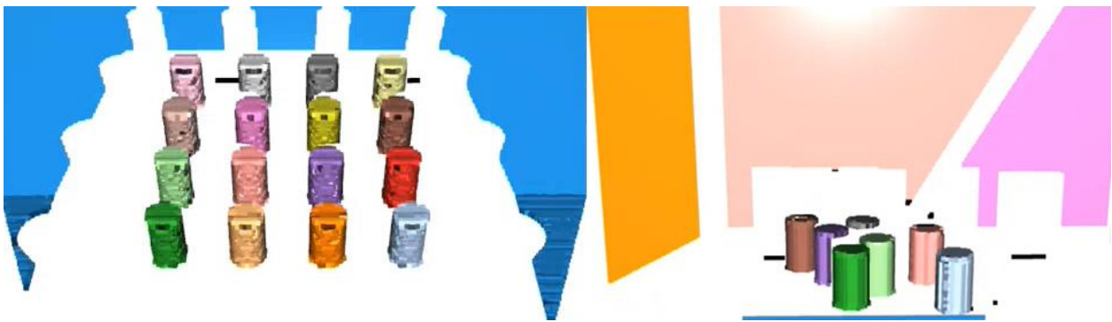
Figura 3.5 Segmentación de nube de puntos para las escenas O (izquierda) y D (derecha)
