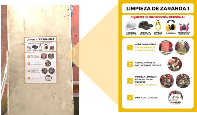
Figura 3.3 Lección de un punto Proceso de limpieza de Zaranda [Elaboración propia]
