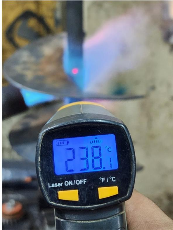
**Figura 3-5 Proceso de soldadura de eje con gusano interior, pre-calentamiento de AISI4340**
