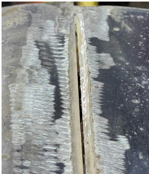
**Figura Apéndice - 10 Preparación de material base previo a soldadura con raíz 3.00mm y ángulo de 60 grados.**
