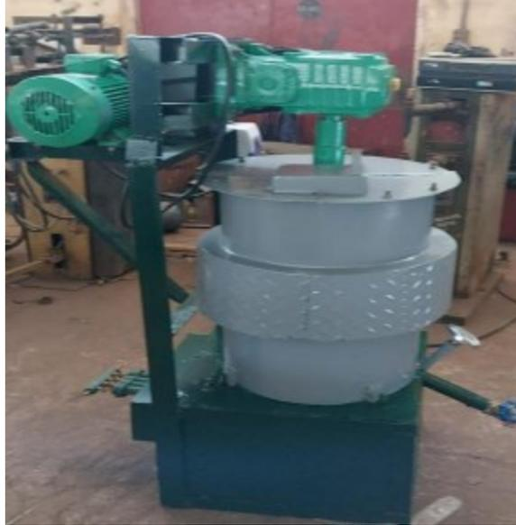
**Figura 2-11 Ejemplo de tipo de Mezcladora con tanque vertical y motorreductor en sección superior.**
