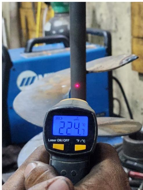
**Figura Apéndice -14 Pre-calentamiento de eje a 250°C.**
