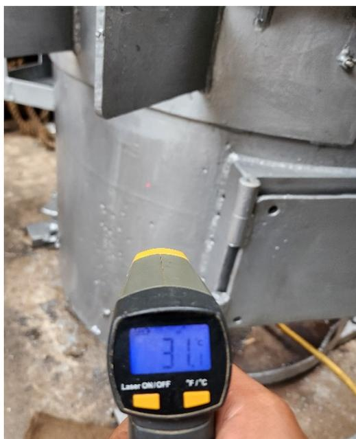
**Figura 3-8 Prueba de temperatura en exterior de tanque con aislante.**
