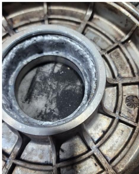
**Figura Apéndice - 12** Relleno con soldadura de aluminio para recuperación de diámetro previo mecanizando a medida de rodamiento nuevo.
