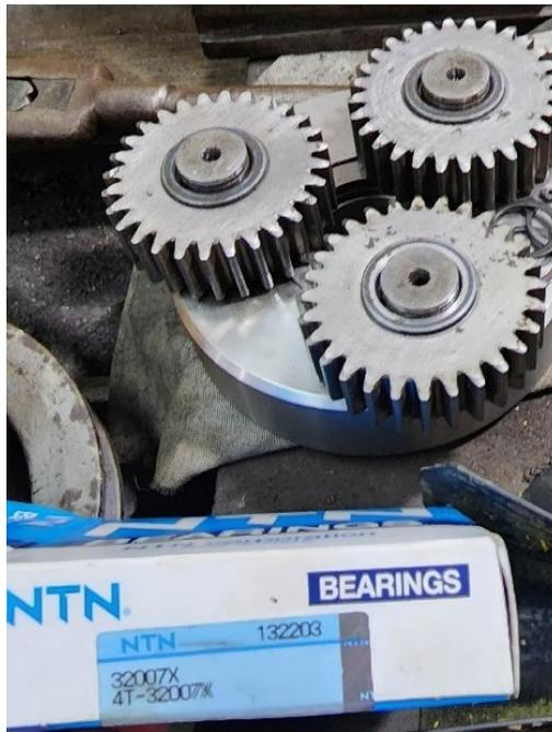
**Figura Apéndice -13 Cambio de rodamientos NTN 3232007X y reparacion de engranajes planetarios.**
