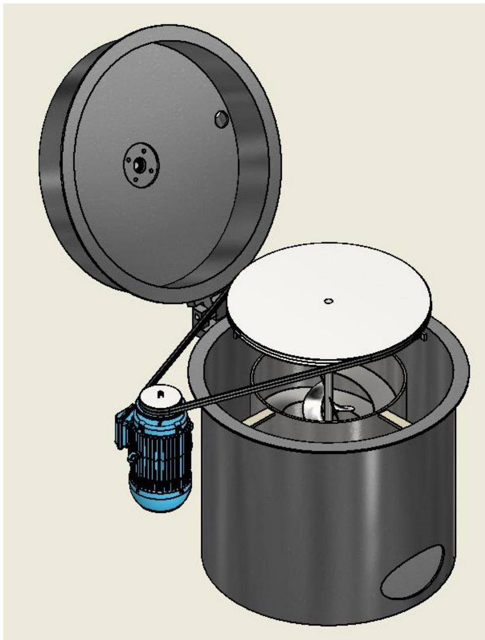
**Figura 3-7** Diseño de tanque conjunto con motor y poleas, tapa abierta para mejor entendimiento de operación.
