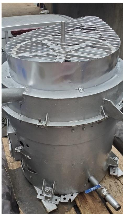
**Figura 3-11 Tanque terminado con guarda para poleas y banda.**
