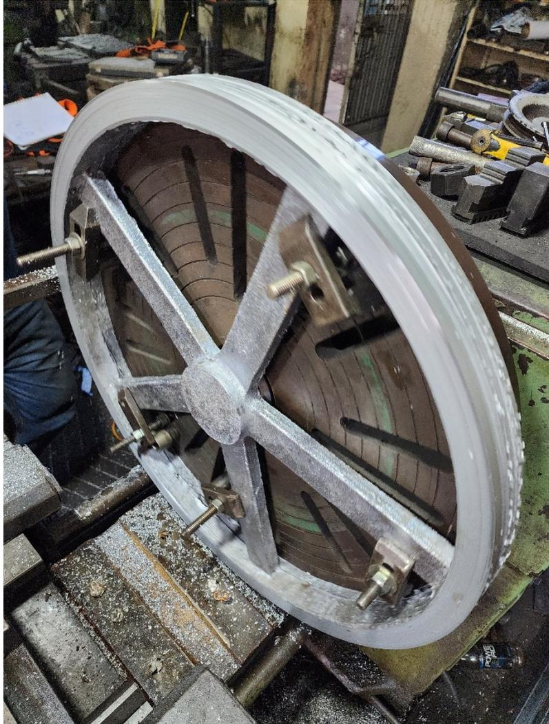
**Figura 3-6 Mecanizado de polea en aluminio según cálculos.**
