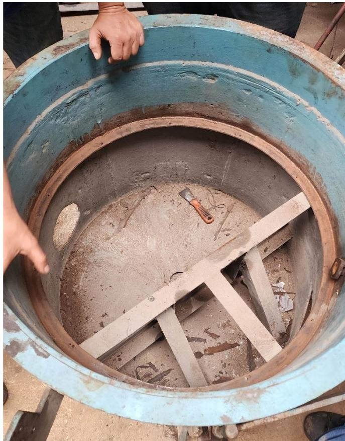
**Figura 3-3 Tanque previo a limpieza y adaptación a diseño de forma.**
