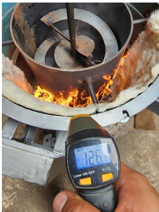
**Figura 3-9 Prueba de temperatura en interior del tanque.**
