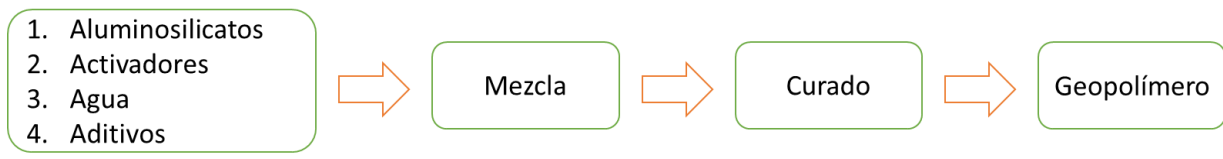
Figura 1.1 Diagrama de flujo esquemático para la producción de geopolímeros [Shehata et al., 2021].
