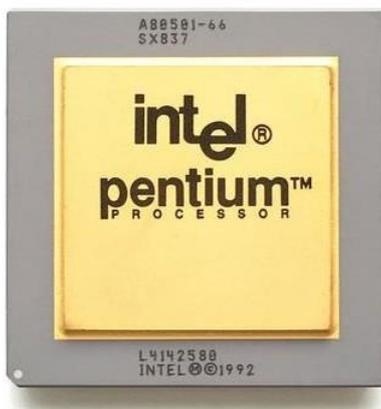
*Ilustración 1: Microprocesador Intel Pentium [38]*
