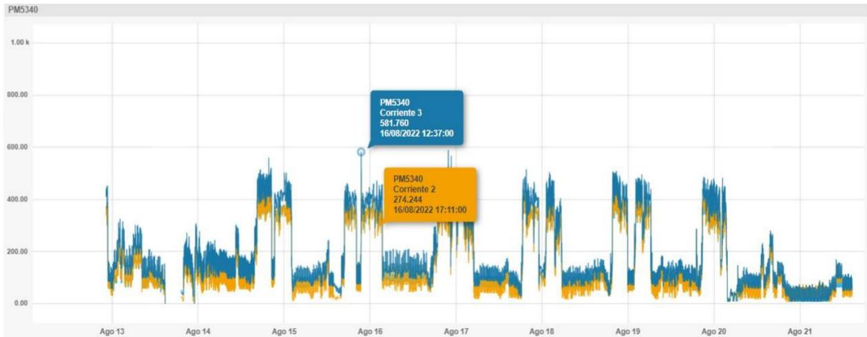
Figura 2.14: corrientes de línea en la salida del transformador de 250 KVA[15]
