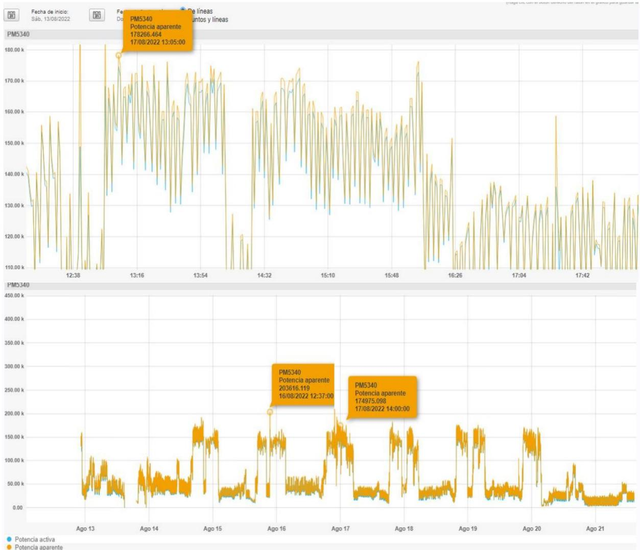
**Figura 2.16: potencia activa y aparente en la salida del transformador de 250 KVA[15]**
