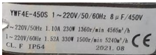
Figura 16. Placa de Datos Característicos del Ventilador
