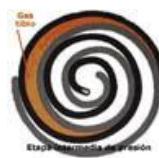
Compresión de refrigerante
