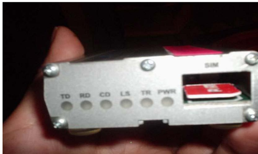
Figura 2-9 Instalación de la SIM card dentro del MODEM
