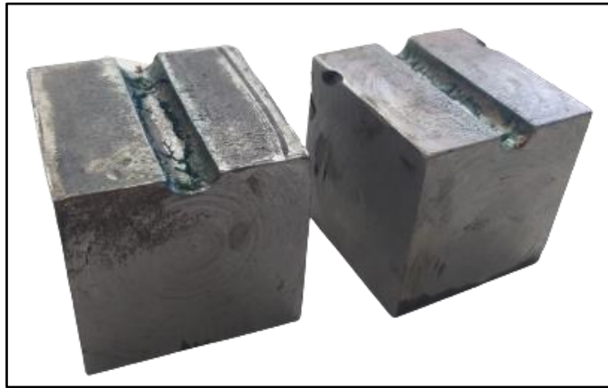
Figura 2.5 Base de soporte simple para las pruebas de pandeo
