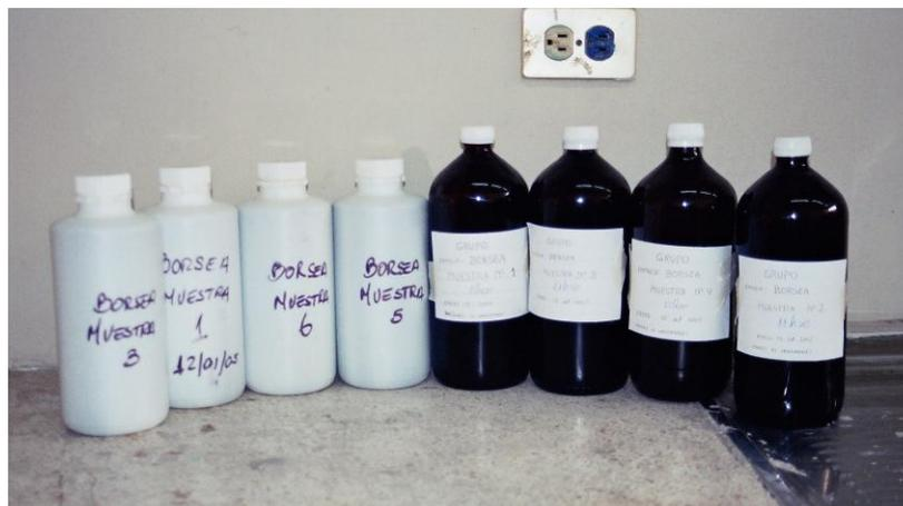
Foto N.- Muestras de agua residual para determinar los parámetros básicos de sólidos suspendidos, aceites y grasa, DQO, DBO<sub>5</sub> y Turbidez
