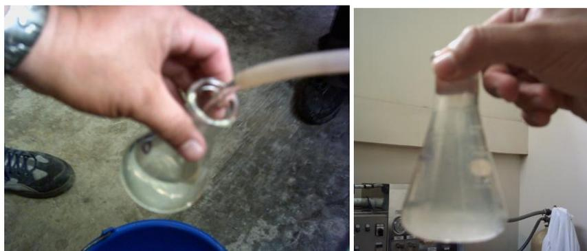
Calidad del agua residual obtenida después del proceso de sedimentación y filtración utilizando el modelo existente en el laboratorio de la Facultad
