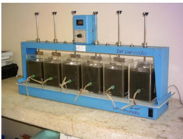
Equipo de prueba de jarras con las muestras de agua residual
