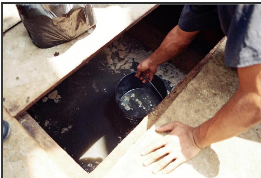
**Fotografía 4.** Toma de muestras para la caracterización de las aguas residuales industriales
